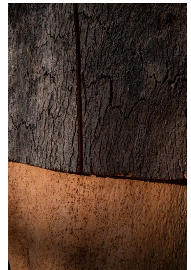
Nahaufnahme von Korkrinde, mit einer modernen Stichsäge geschnitten
